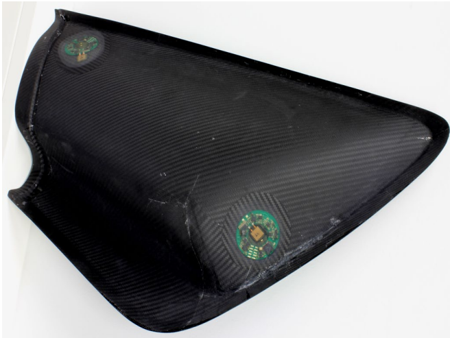
Systemintegration in CFK-Formteil der Firma Cotesa GmbH.
